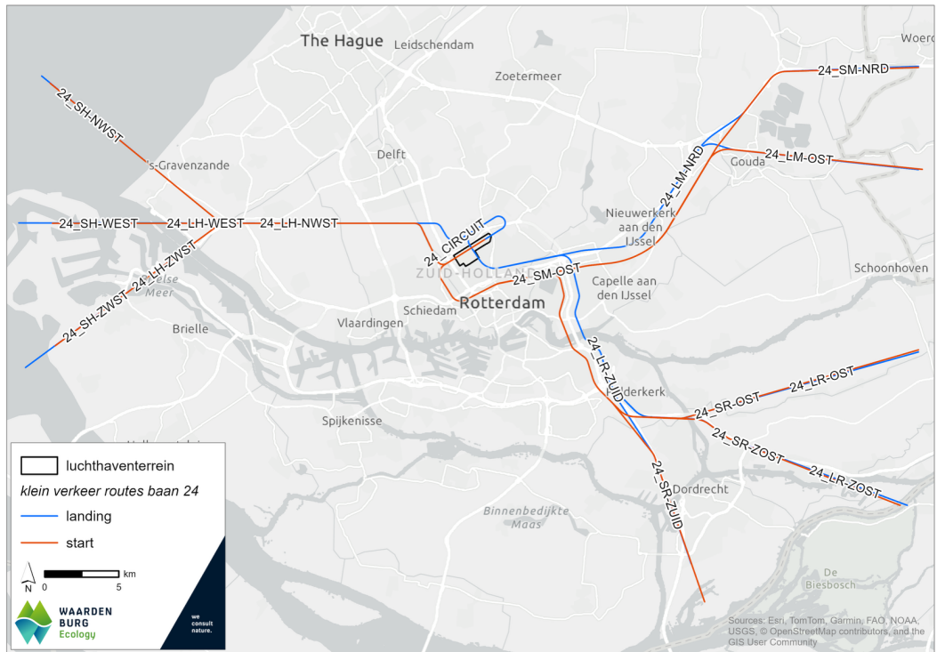
Figuur 2.2 Routestelsel klein verkeer op RTHA bij gebruik van baan 24 (bron: Adecs Airinfra).
